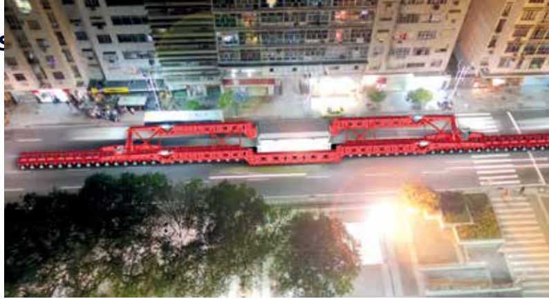
Projektbild der neuen Goldhofer/Greiner Scherenhubbrücke mit 64 Achse
