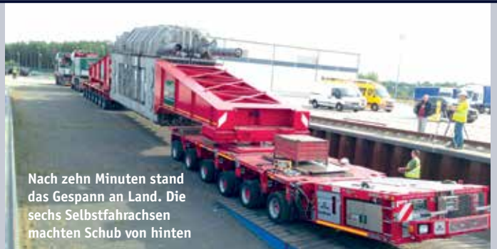
Umschlag des Transformators im Hafen Schönebeck auf die vorbereiteten Lastverteiler im Schubleichter LASTDRAGER 40 | Bild: Kahl
