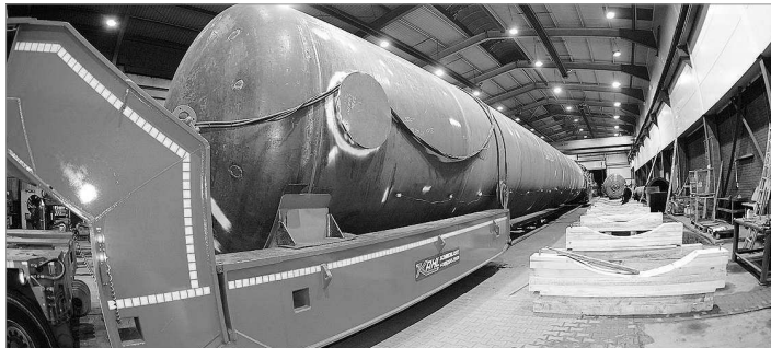
Die Ruhe vor der Abfahrt: Die Seitenbeleuchtung am dem Gas-Buffer ist montiert, die Polizei hat den Transport nachgemessen und für in Ordnung befunden.
