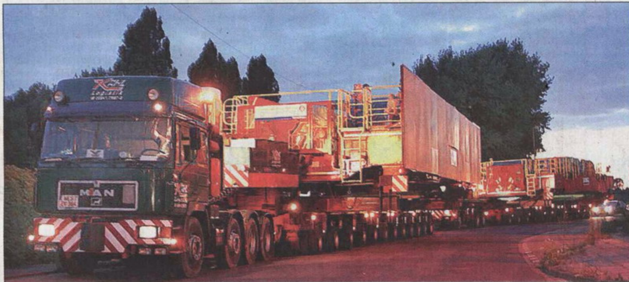
Ein 40 Meter langer und 263 Tonnen schwerer Spezialtransport wie dieser rollt auf Kierspe zu. Allerdings wird nur nachts gefahren. Befördert wird eine riesige Mahlschüssel. Erwartet wird das Monstrum in der Volmestadt in der nächsten Nacht.
