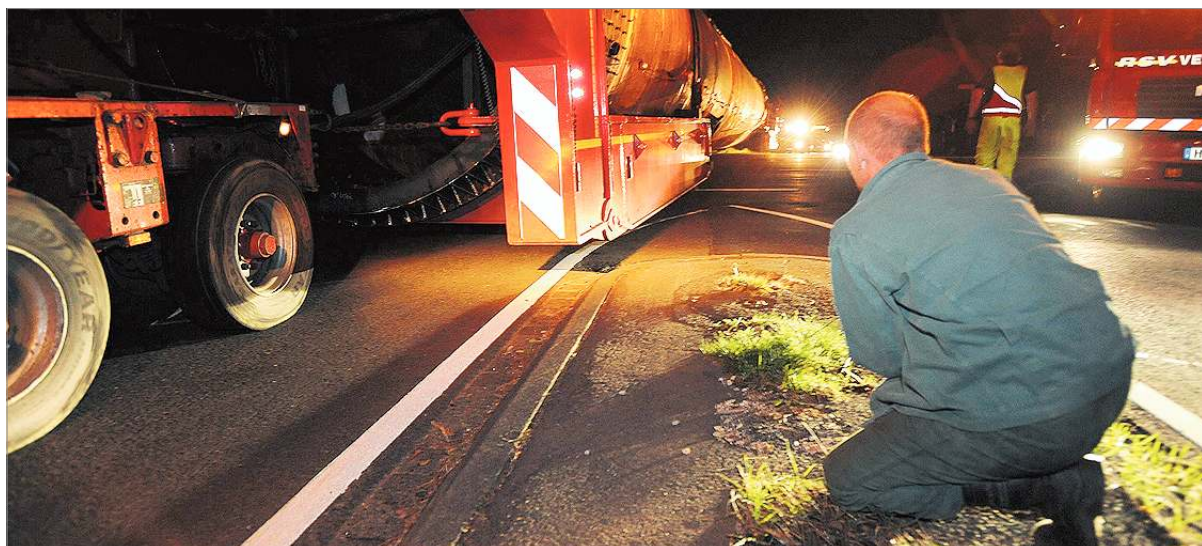
Bei Verkehrsinseln ist Millimeterarbeit gefragt. Der Fahrer erfährt nur per Funk von seinem Einweiser, wie er steuern muss und ob er seine Fracht hydraulisch anheben muss.
